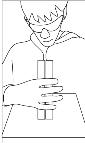
Figuur 9. Kleurvergelijking bij colorimetrische analyse
